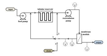
Fig. 11. RO Subsystem Schematic
